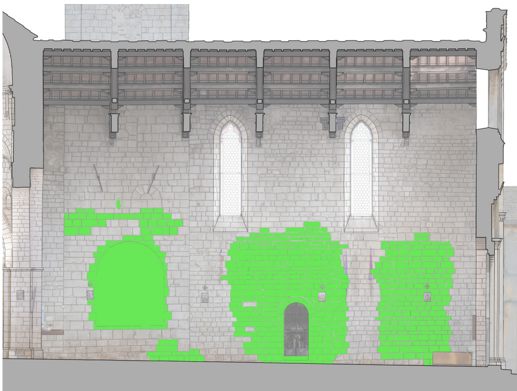
35 Identificazione delle lastre di travertino poste in opera con l'intervento del 1954
